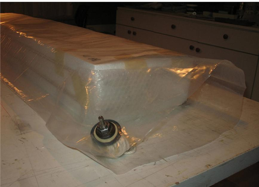
On aura pris la précaution de tirer une ficelle de gros diamètre du bout jusque vers l'avant. La pièce de sous-tirage de l'air se placera juste dessus ce qui évitera au sac de boucher la sortie par collage sous l'effet de la succion.
