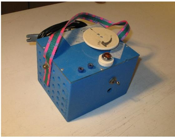
Le transfo AC/DC avec son large potentiomètre pour ajuster précisément la température souhaitée.
