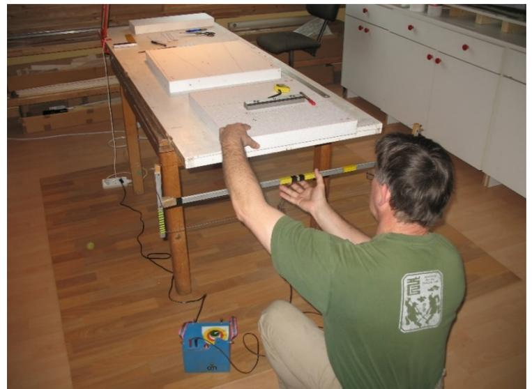
On trouve le milieu du trait de découpe sur le bloc, puis on pose le fil de façon que l'arc descende par son propre poids sans se mettre de travers.
