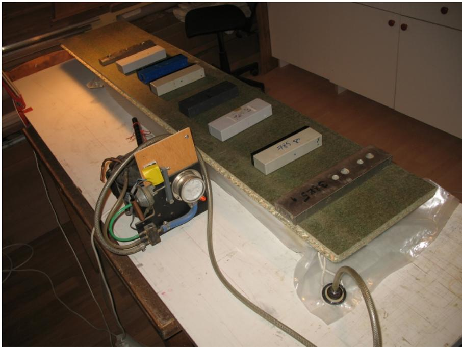
Je dispose des poids sur la longueur totale du sac, le tout sur une planche qui recouvre complètement la surface afin de répartir la pression. Sans cela on verrait apparaître une courbure du sac dans le sens de la longueur sous l'effet de la succion.
