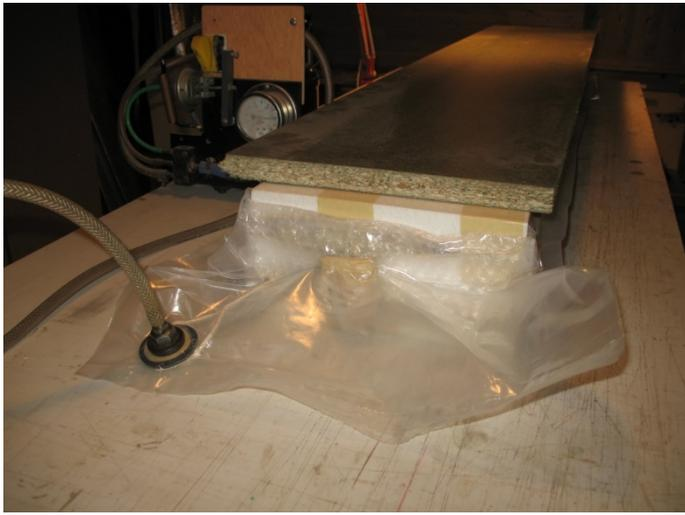
On raccorde au tuyau de la pompe à vide et on laisse fonctionner environ 24h pour assurer un bon séchage.
