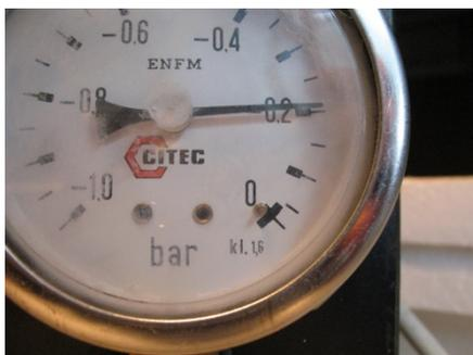
**LA BONNE DEPRESSIION** Pour le polystyrène expansé, la plage de travail se situe aux alentours de -0,20 bars. La pression exercée sur l'extérieur du sac doit servir à plaquer correctement le coffrage sur le noyau, au-delà on écrase l'aile au risque de modifier irréversiblement le profil !
